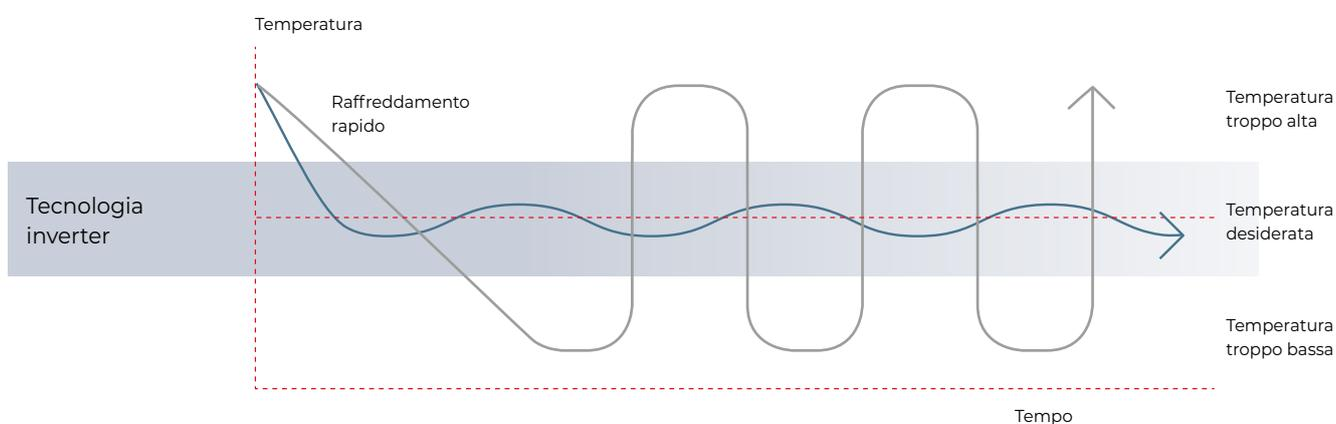
\* Il controllo inverter TOSHIBA utilizza due diversi tipi di azionamento per il compressore: si utilizza la modulazione di larghezza di impulso (alta efficienza/PWM) per un funzionamento molto efficiente a carico parziale o la modulazione di altezza di impulso (alta potenza/PAM) per raggiungere rapidamente la temperatura nominale impostata.
