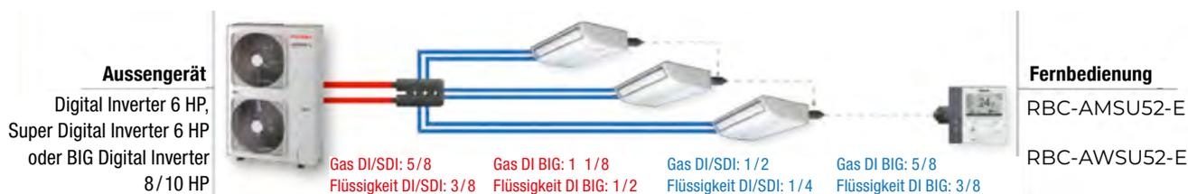
Gesamtlänge SDI-DI < 50 m, DI BIG < 70 m | Max. Rohrlänge < 15 m | Höhenunterschied < 30 m
