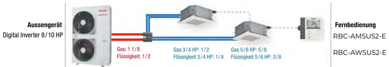
Gesamtlänge < 70 m | Max. Rohrlänge < 15 m | Höhenunterschied < 30 m
