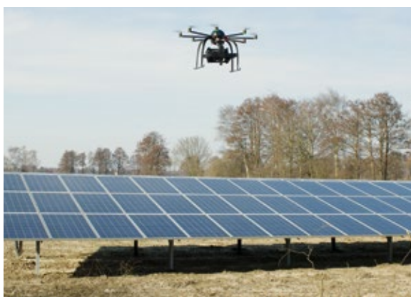
Drohne mit Thermografiekamera für Qualitätssicherung von Fotovoltaikanlagen oder Gebäuden
