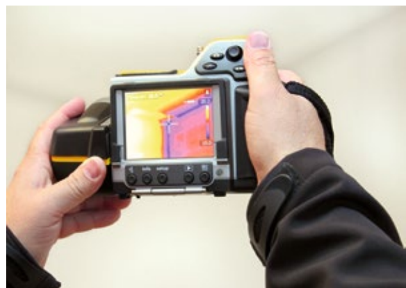
Thermocam-Analyse auf Schwachstellen in einer Wohnung
