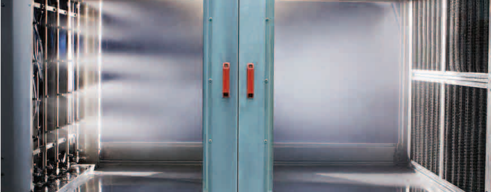
Luftkanal-Test im CAREL-Labor: Bis zu 95% des Zerstäubungswassers werden von der Luft absorbiert, die somit effizient befeuchtet und gekühlt wird und den Wasser- und Stromverbrauch auf ein Minimum senkt.
